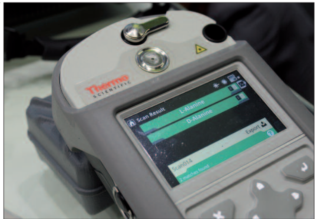
TruDefender: Substanzen wie Explosiv- und Kampfstoffe sowie Drogen werden mittels Infrarot-Spektrometrie identifiziert.
