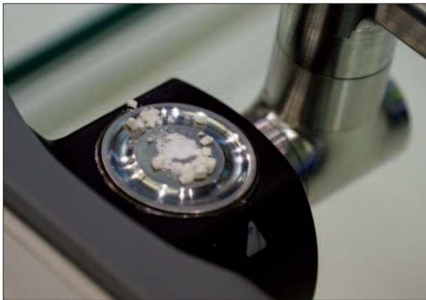
TruDefender: Substanzen wie Explosiv- und Kampfstoffe sowie Drogen werden mittels Infrarot-Spektrometrie identifiziert.
